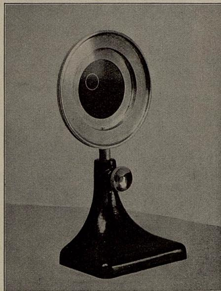
Drehapparat für eine Lichtspaltplatte. — Rotary apparatus for a diaphragm. — Appareil de rotation pour un diaphragme.
