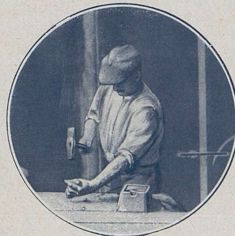
Figure extraite du film obtenu sous la direction de Monsieur Frois pour l'analyse cinétique du coup de marteau. Une échelle graduée placée à droite permet de mesurer l'espace.
