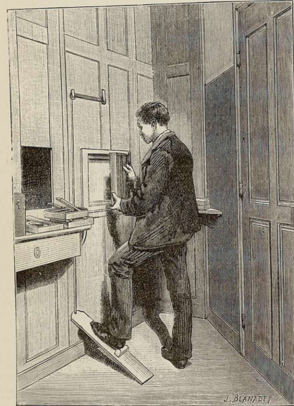
Fig. 1. — Vue de l'opérateur faisant manœuvrer une trappe spéciale pour l'impression des papiers positifs au gélatino-bromure d'argent. Cette organisation abrège le travail en permettant à plusieurs personnes de travailler dans le même laboratoire aux opérations différentes du développement et du tirage.
