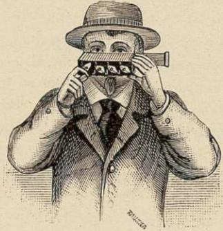
En prenant simultanément deux vues d'un même sujet avec le premier et le dernier objectif, on obtient un cliché stéréoscopique.
