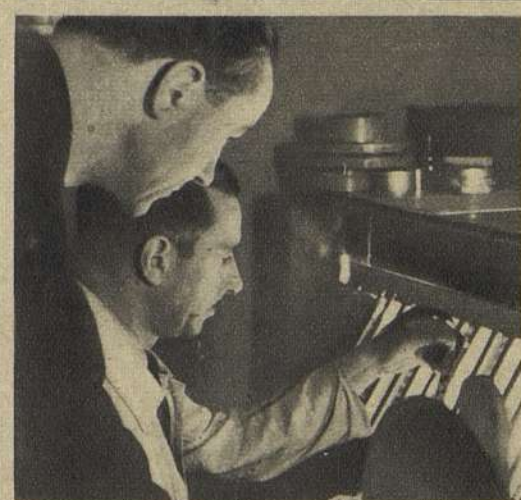
ETALONNAGE : Pour que tout le journal ait la même tonalité, l'étalonneur classe les sujets suivant leur luminosité et en indiquant les différences de couleur permet de développer pour obtenir un ton uniforme.
