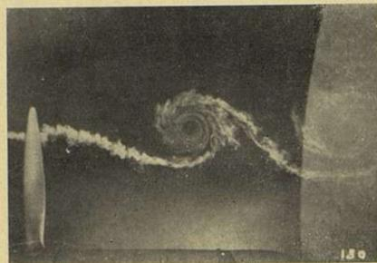
Remous produit en arrière d'une pale d'hélice tournant dans une soufflerie. Le remous est décelé par un filet de fumée (Photo au millionième le seconde prise avec le Stroborama.) (Photo R.M.P.)
