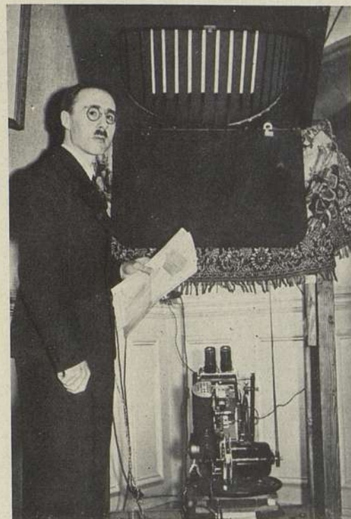
M. François Savoye devant l'appareil qu'il a inventé. On voit en bas l'appareil de projection de 16 m/m. à double objectif et, en haut, le tambour qui tourne devant l'écran. (Photo F. Savoye)
